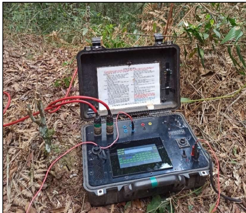
Figura 5: Resistivímetro ABM AL-48 utilizado para o levantamento geofísico.
